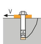
→ Résistance à la rupture par effet de levier pour béton sec, humide <sup>(1)</sup> et immergé <sup>(2)</sup>
